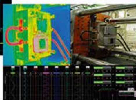
视频输入 兼顾网络摄像头、热像仪和 高速摄像机的同步视频采集
