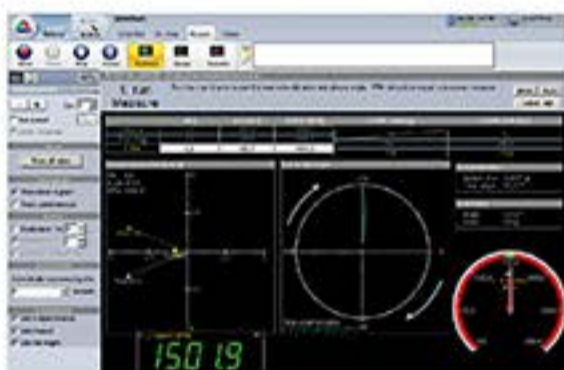
自动生成界面引导用户 完成动平衡过程
